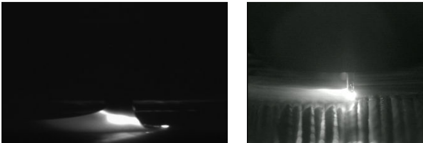
Abbildung 3: Seitliche Prozessbeobachtung; links – einfache Sensorik, befiltert, rechts – HDR-Sensorik
