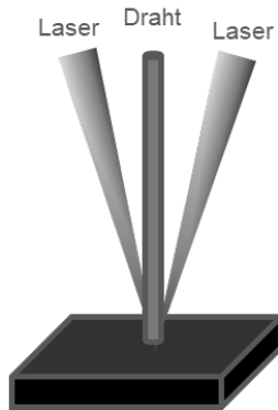
Abbildung 2: Schematische Darstellung der zentrischen Drahtzuführung.
